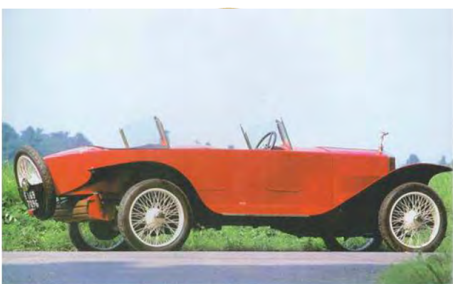
この画像はボディはフランス・リボンのルージュというほど鮮やかな赤で、これはドイツ・メルセデス・ベンツの作品。3000ccの直列6気筒エンジンを搭載している。
